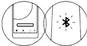
• Натисніть кнопку «сканувати» для підключення до вашого електросамокату. Електросамокат подасть звуковий сигнал, коли з'єднання буде успішним. Значок Bluetooth перестане блимати і залишатиметься підсвіченим.
