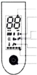
Режими: доступні три режими "ECO" для енергоощадного режиму (плавне прискорення, підходить для початківців). D для стандартного режиму та S "для спортивного режиму (рекомендований лише для досвідчених водіїв)
